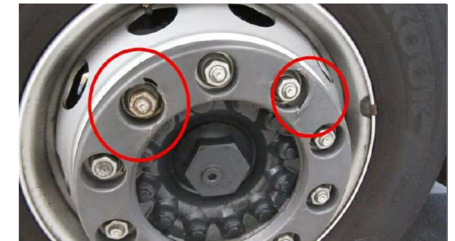
Wioldoppen: Vervormd, gebroken, materiaal ontbreekt of compleet verwijderd
