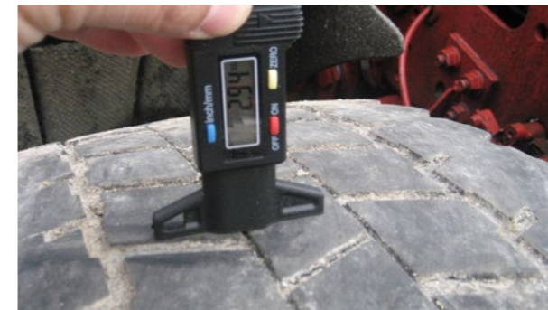
Banden: Inrijding > 3 mm diep, demontage
