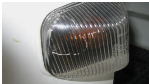
Voor- en achterlichtunits gebroken
