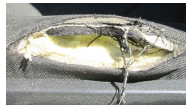
Vulling ontbreekt of gebroken frame
